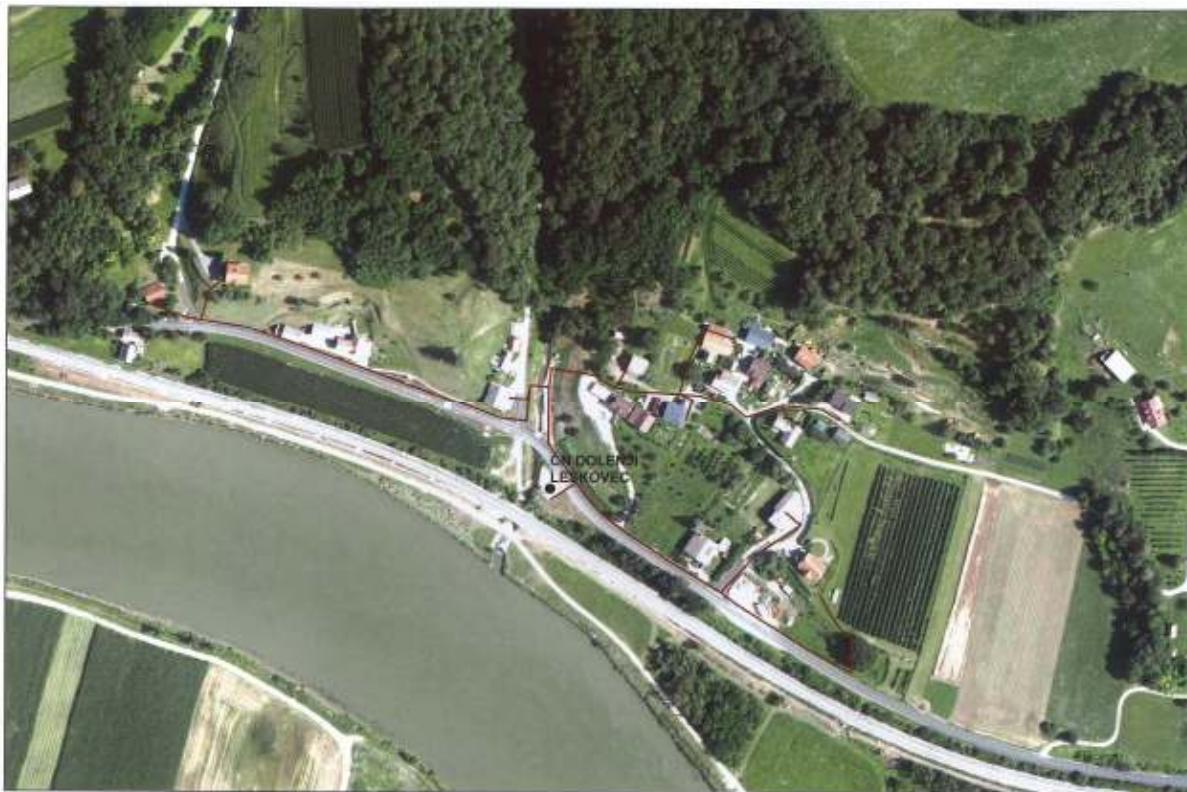
Slika 5: Ortofoto posnetek z vrisom kanalizacije Dolenji Leskovec
