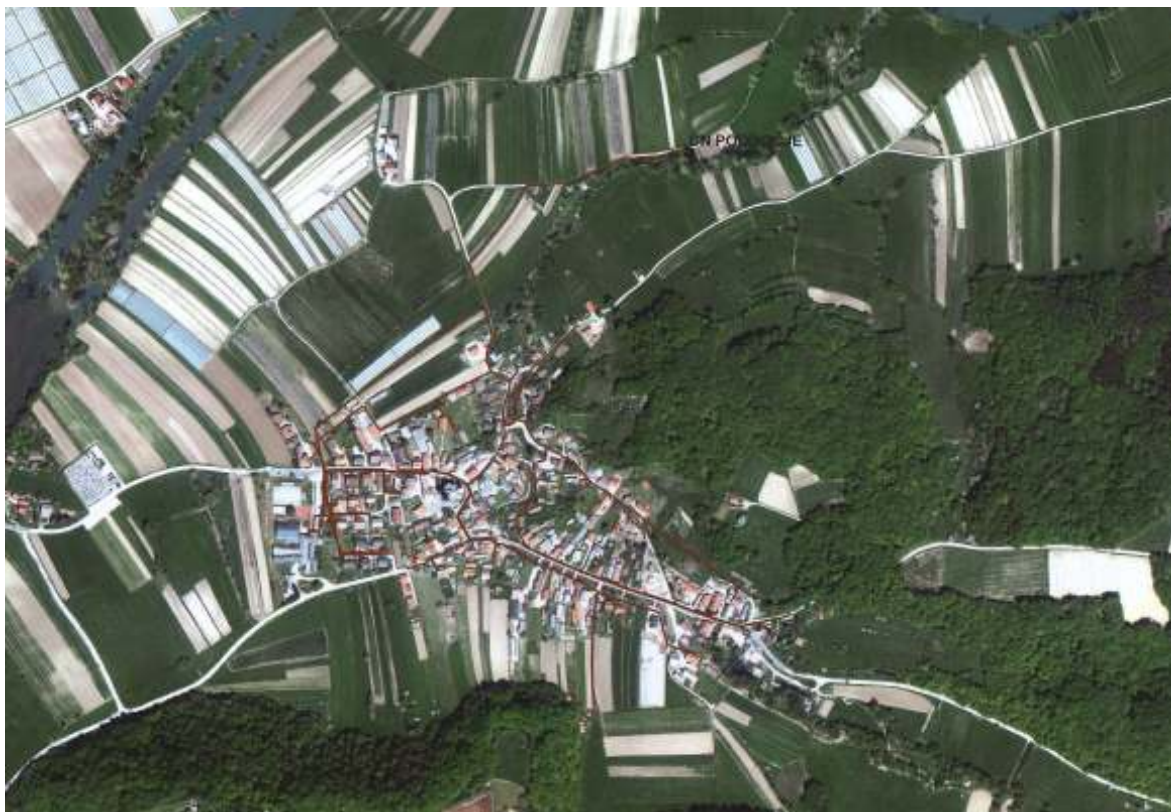
Slika 6: Ortofoto posnetek področja kanalizacijskega sistema Podbočje z vrisom kanalizacije
