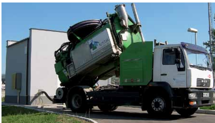
Prezem grezničnih odplak na novozgrajenem objektu kanalizacije Krško
